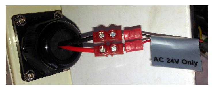
正極電源線接正極電源接頭並鎖緊,負極電源線接負極電源接頭並鎖緊
