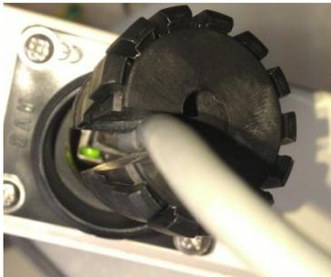
防水橡胶塞入束线头孔径内
