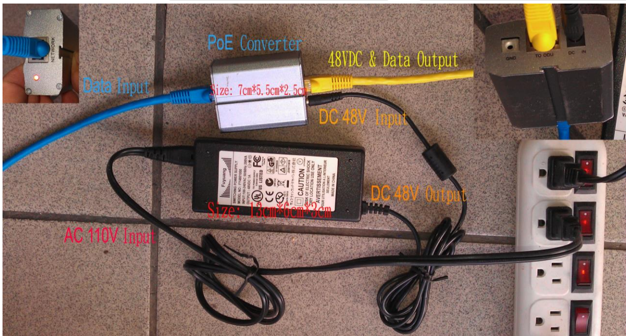
PoE 乙太網路供電整合器 RJ-45 乙太網插孔，連到無線設備 DC 電源插孔，連接到變壓器
