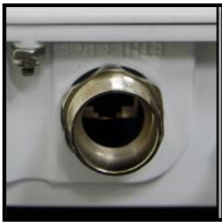
無線設備下方 PoE 乙太網路防水插孔
