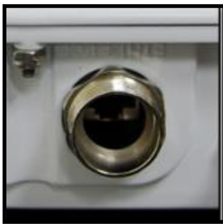
无线设备下方 PoE 以太网防水插孔
